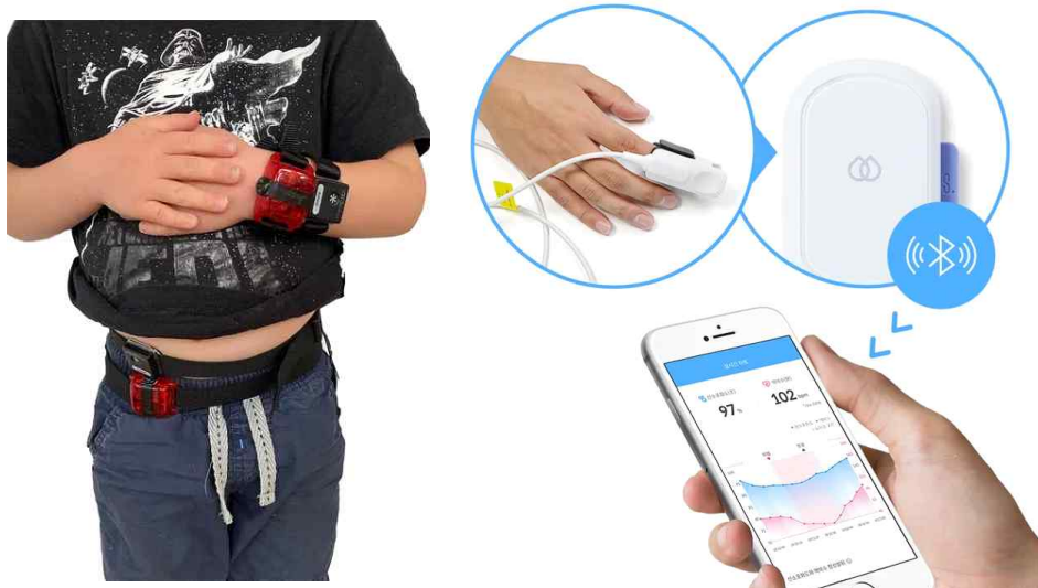
그림 3. 원격 심장재활을 위한 웨어러블 센서의 예시: 손목 또는 복부에 차는 형태의 센서인 액티그래피(왼쪽)와 산소포화도를 모바일 디바이스로 실시간 모니터링할 수 있는 센서인 송아리에어(오른쪽).
